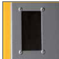
Screen for blade centering. Visor para centrar la cinta.
