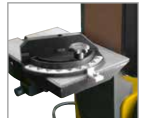
Sander in vertical position with workbench and goniometer. Lijadora en posición vertical con mesa de trabajo y goniómetro.
