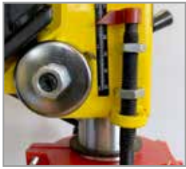
Graduated rod for drilling depth adjustment Varilla graduada para ajustar la profundidad de perforación
