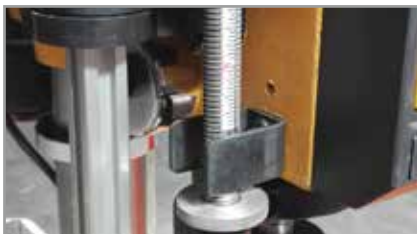
Graduated rod for adjusting the drilling depth to assure precise machining and serial jobs. Varilla graduada para ajustar la profundidad de perforación: para un mecanizado preciso y en serie.
