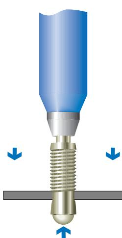
Azionando l'utensile al chiodo viene applicata una forza di trazione che deforma la parte tubolare del rivetto.
